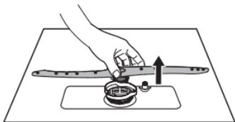
Para remover o braço de pulverização inferior, puxe estique o braço de pulverização para cima.
