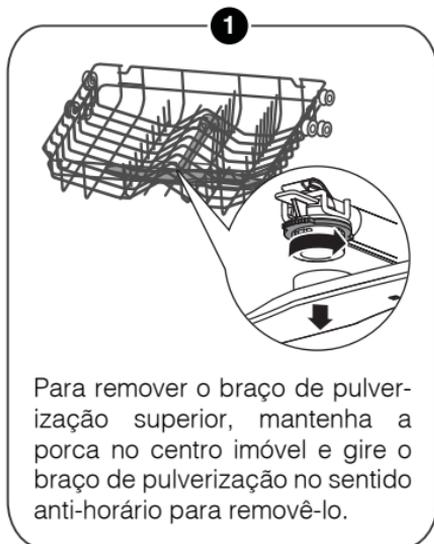
Para remover o braço de pulverização superior, mantenha a porca no centro imóvel e gire o braço de pulverização no sentido anti-horário para removê-lo.
